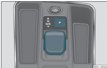
156. att. Viduskonsolē: selektora pārslēgs.
