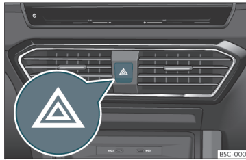
96. att. Instrumentu panelis: avārijas gaismu signalizācijas slēdzis.
