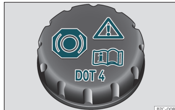
219. att. Motora nodalījums: bremžu šķidrums tvertnes vāciņš.
