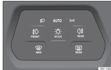
94. att. Instrumentu panelis: gaismu vadības panelis.
