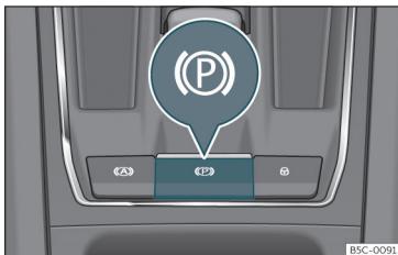
186. att. Viduskonsoles apakšdaļā: elektroniskās stāvbrezves taustiņš.
