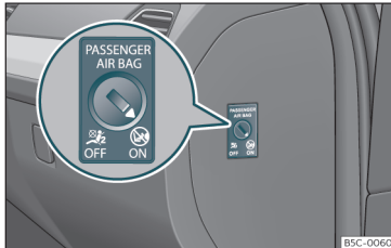
19. att. Ar atslēgu pārslēdzams slēdzis priekšējā pasažiera drošības spilvena pieslēgšanai un atslēgšanai.
