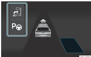
189. att. Mērinstrumentu bloka ekrānā: novietošanas manevra palīga rādījums ar ierobežotu skatu.
