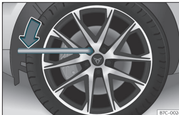
41. att. Riteņa nomaīņa: riteņa skrūvju palaišana vaļīgāk.
